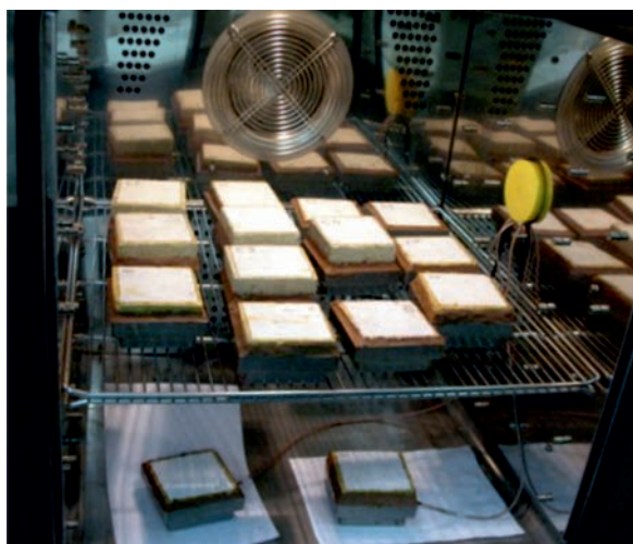
Obr. 1. Měření parametrů transportu vodní páry v závislosti na teplotě
